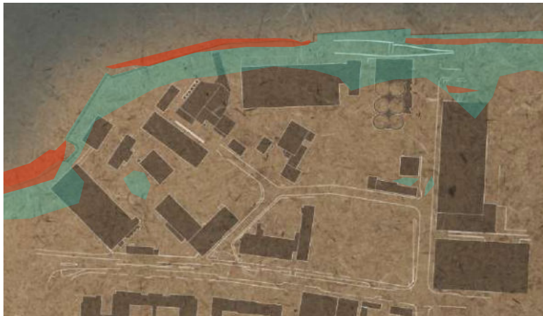
Figur 43. Vid ett 100-års regn finns enligt Myndigheten för samhällsskydd och beredskap stor risk för att delar av Lövholmens nuvarande marknivå kommer att täckas av över 1.5 m vatten.
