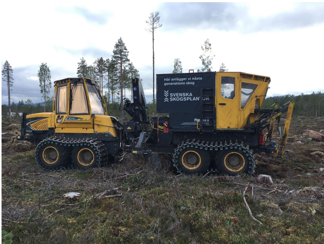
Figur 5. Planteringsmaskinen Plantma X på en av Sveaskogs trakter i södra Norrland. (Foto: Linnea Tysklind).
