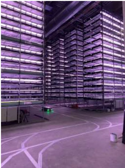
Figur 8 Transporter i Nordic Harvest anläggning i Köpenhamn med AGV (automated guided vehicles för interna transporter). Källa: Nordic Harvest presskit.
