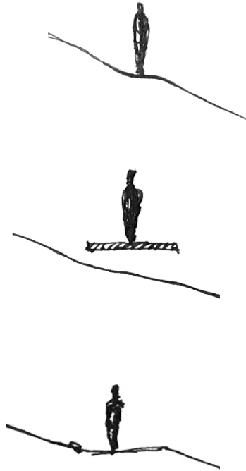
Fig. 37: Visar tre olika alternativ för att ta sig ned för slänten. Överst: Ett alternativ som bygger på en smal gångyta, typ stig. Mitten: En lösning som svävar ovan slänten, typ ramp. Underst: En större plan gångyta skapas, typ åsnestig.
