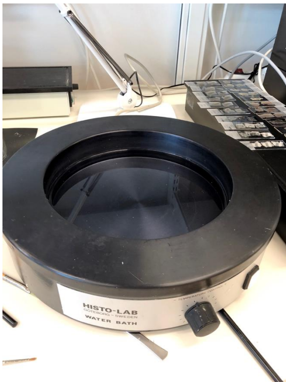
Figur 2. Till vänster: vattenbad för att släta ut veck i preparaten. Till höger: mikrotom.
