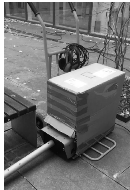
(Figur 55) Rökmaskinen isolerades med hjälp av hönsnät och textil i en låda av kartong för att dämpa ljudet, men också för att dölja själva maskinen. Lådan bidrog också till att maskinen höll värmen, en förutsättning för att röken skulle kunna produceras. 2019-10-30.
