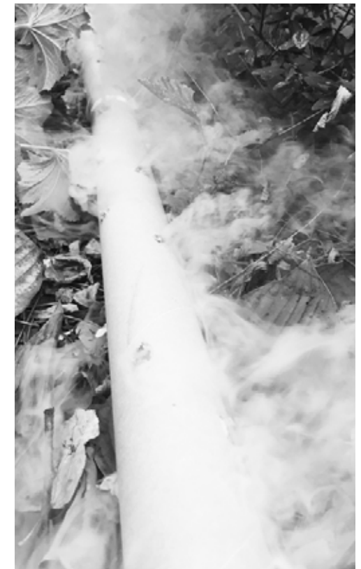
(fig. 45) Test med rökmaskinen på innergården i Bio Centrum. Det perforerade pappröret användes för att sprida röken så att den blev mer dimlik. Papprören hade dimensionerna 90 mm i diameter och var 100 mm långa, hålen borrades med ca 200 mm mellanrum och var 10 mm i diameter. Fyra papprör monterades ihop. 2019-10-23.
