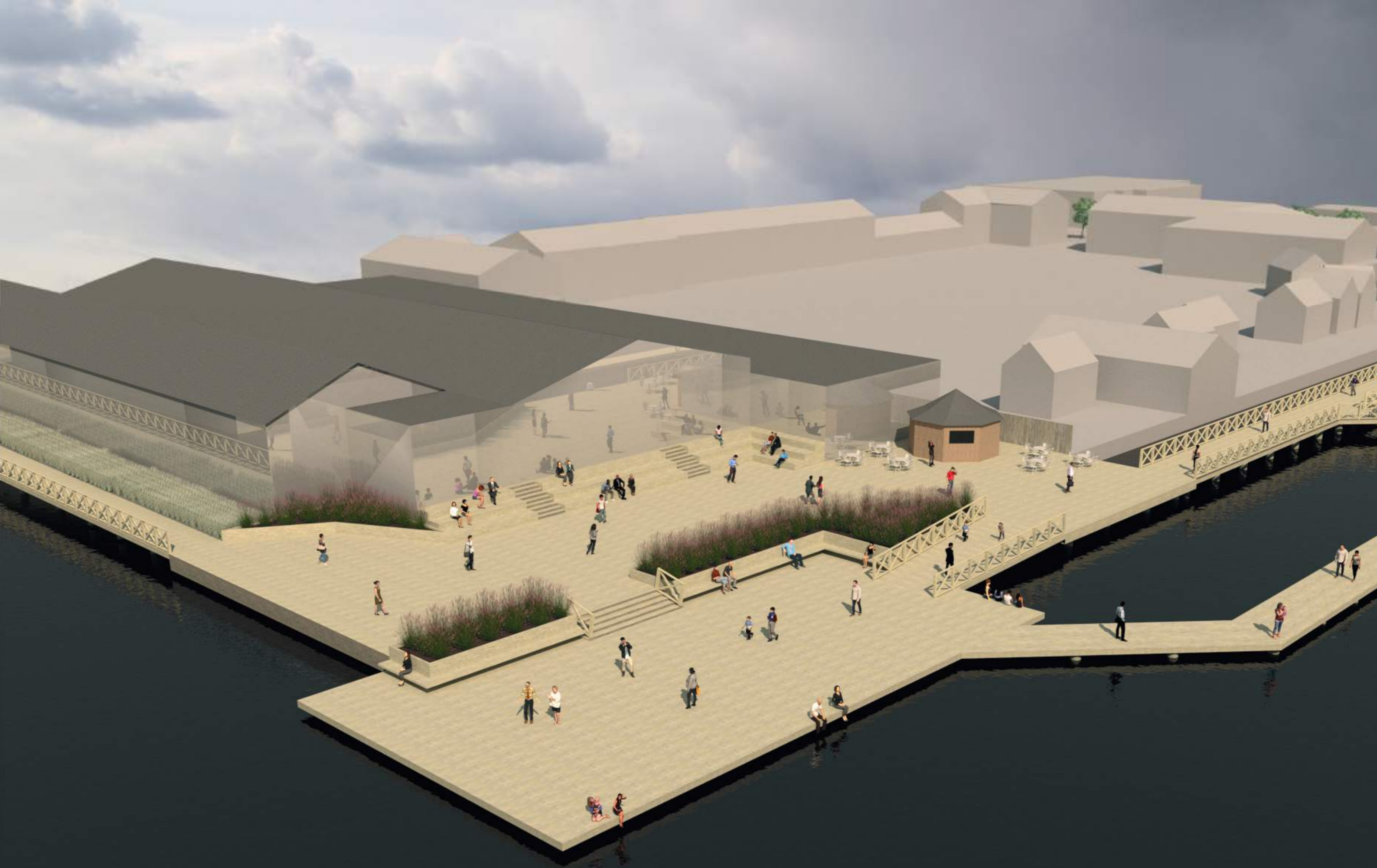
Figur 82. Perspektiv över terrassen. Här visas hur terrassen är uppbyggd med en övre och en nedre del, samt hur spårvagnshallarnas fasader skulle kunna se ut om de kläddes med ett reflekterande material.
