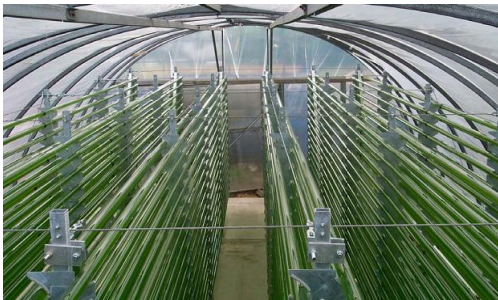
Tubular photobioreactor inside greenhouse (Berg-Nilsen, 2006)
