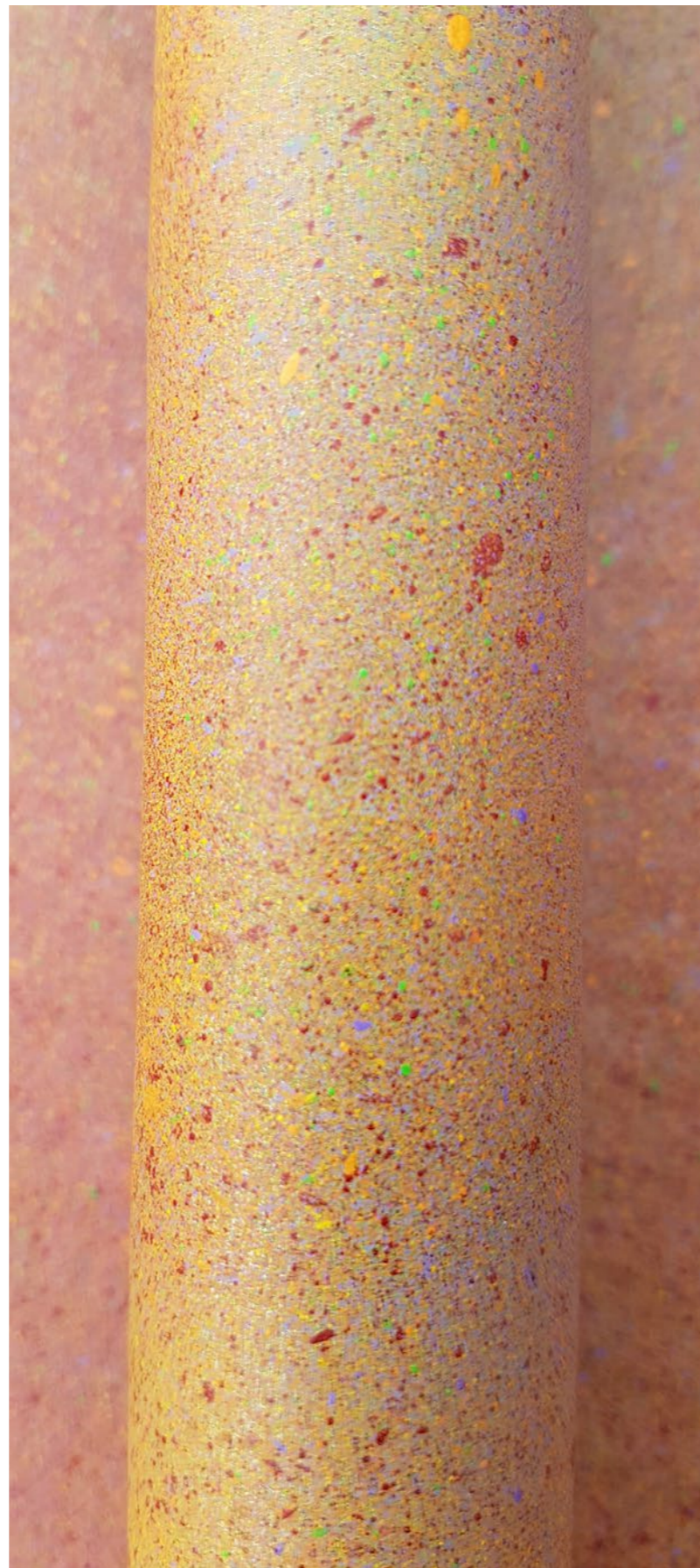
BILD 23. Förlaga till materialprov. Skiss gjord i skala 1:1 med hobby sprayfärg i olika kulörer som sprayats på ett stålrör.
