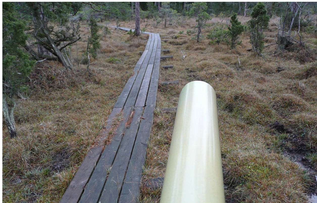
BILD 26. Samma materialprov från Lappset jämförs med våtmarken men från en annan vinkel. Ljusreflektioner bildas på den glansiga ytan och färgupplevelsen blir att stålet inte smälter in med omgivningen.
