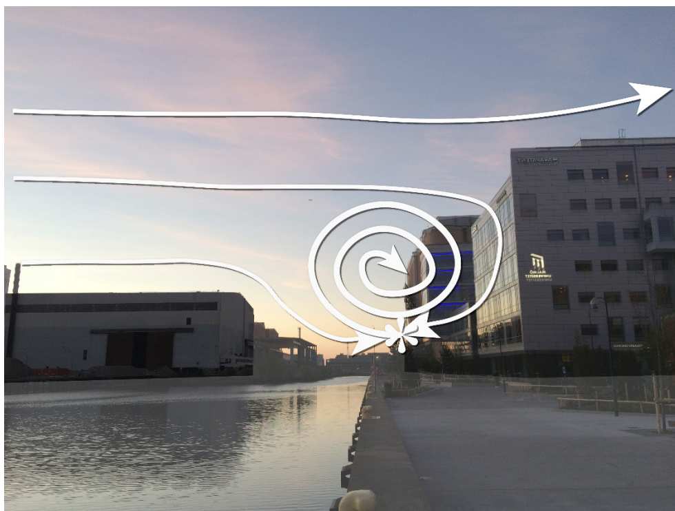
Figur 7: Bilden visar hur vindens rörelse påverkas om ett lägre hus ställs framför ett högre. Illustrationen är baserad på Oke (1978) Boundary layer climates s. 237.
