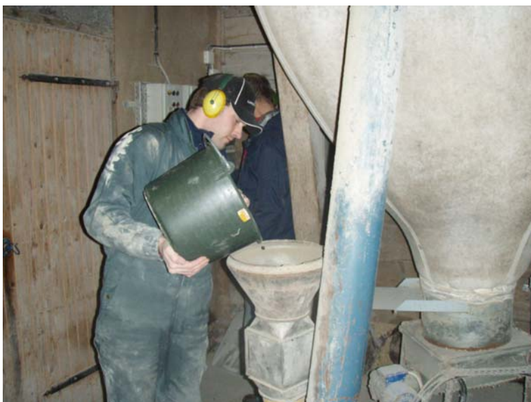
Figur 4: Malningstest av åkerbönor i skivkvarn. Foto: Hans-Olof Johnsson, (2007).
