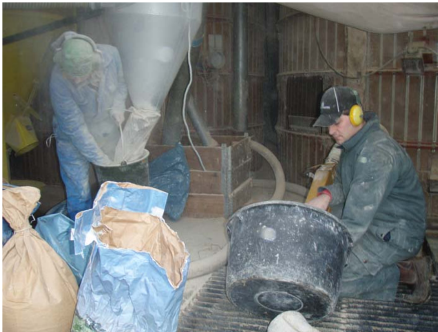
Figur 12: Dammförekomsten vid maning i hammarkvarn och hur vi fördelade testsatserna. Foto: Hörndahl Torsten, (2007).
