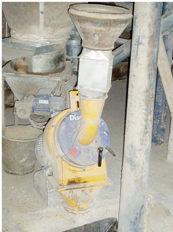
Figur 3: Skivkvare som användes vid malningstesten.
