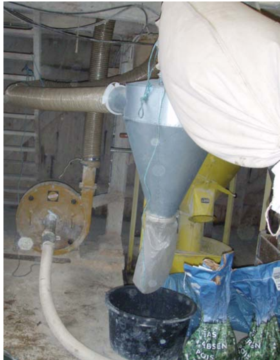
Figur 5: Malningstest med hammarkvarn och längst fram syns cyklonen.
