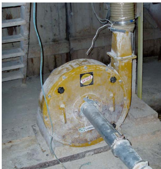
Figur 2: Hammarkvarn som användes vid malningstesten.
