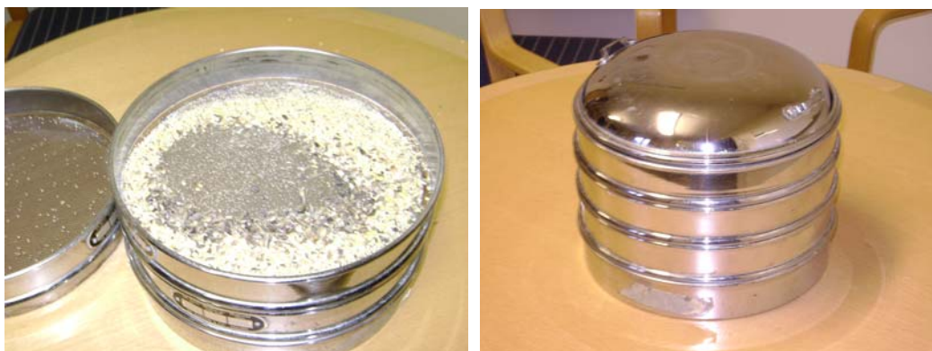
Figur 6: Vid siktningsförsöken användes en sju delars sikt.
