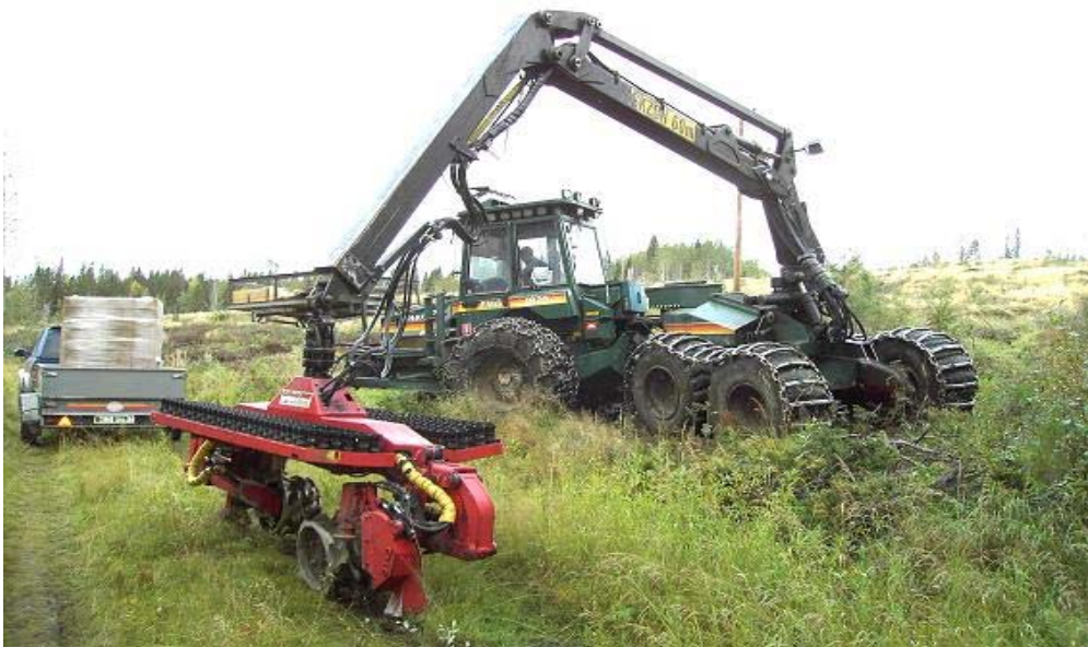
Figur 1. Det maskinsystem som sommaren 2005 var i drift inom Holmen Skog AB:s region Iggesund. Basmaskinen är en FMG 1870 utan runtomsvängande hytt och med operatören långt från planteringsaggregatet.
