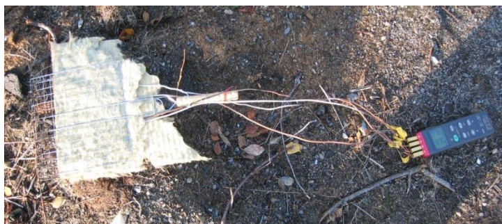
Figur 7. För att mäta temperaturen inne i contortakottar när de utsätts för öppen låga i olika tider, användes en datalogger med fyra termoelement av typ K. En större och en mindre kotte brändes samtidigt, med ett termoelement i centrum av vardera kotten. Två termoelement placerades bredvid dessa kottar för att mäta temperaturen direkt i lågorna.
