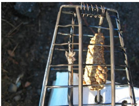
Figur 6. Kottarna fördes in i elden fasthållna i ett halster. Intill kottarna fästes ett termoelement för att notera temperaturen i lågorna och den reella exponeringstiden.
