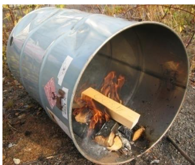
Figur 5. Anordning för experimentell exponering av contortakottar för eld. En liggande tunna användes för att få vindsydd. När elden var tillfredställande placerades ett halster med contortakott samt termoelement i elden. Elden som användes till experimenten var betydligt större än den som visas på bilden.
