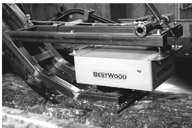
Figur 7. Mätanordning för NIR då materialet rör sig på transportband.( Foto: Bestwood 2007). Figure 7. Measuring moisture content in wood chips with NIR. (Photo:Bestwood 2007).
