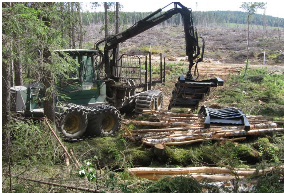
Figur 2. En skotare som arbetar med den portabla bron. Figure 2. A forwarder working with the portable bridge.
