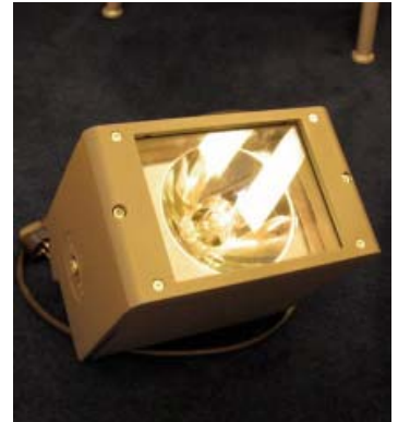
Till vänster: Contrast Pinspot #77 630 08, Thorn 35 W 230V metallhalogen MR PAR 20 E 27 3000K, spridningsvinkel 30°. IP 65
