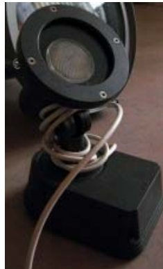
Till vänster: Contrast Pinspot #77 630 08, Thorn 35 W 230V metallhalogen MR PAR 20 E 27 3000K, spridningsvinkel 30°. IP 65
