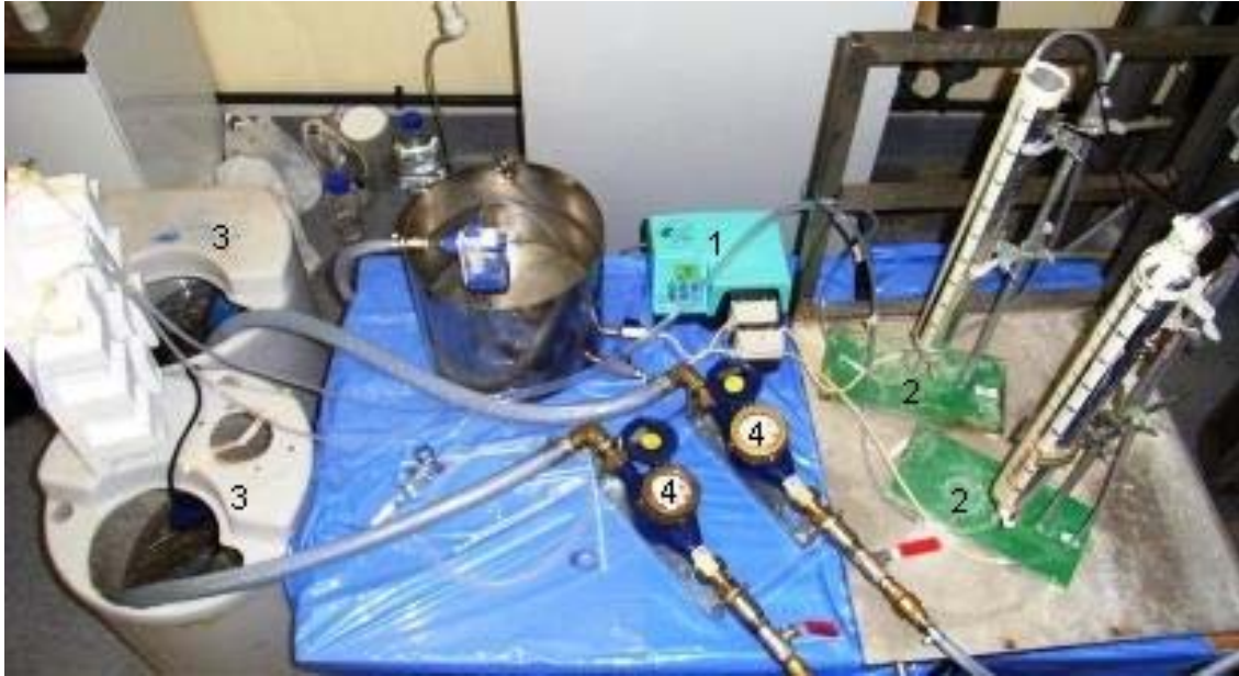
Figur 7 Fotografi av uranpiloten. Råvattnet pumpades via en slangpump (1) med ett konstant flöde till kolonnen med jonbytarmassa (2). Det behandlade vattnet samlades upp i uppsamlingskärl (3) innan volymen mättes med en vattenmätare (4). Under försöket testades två jonbytarmassor parallellt i var sin kolonn med tillhörande uppsamlingskärl och vattenmätare.
