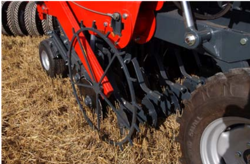
Fig. 6. Det tandade järnhjulet driver utmatningen. (AGCO AB, 2004)
