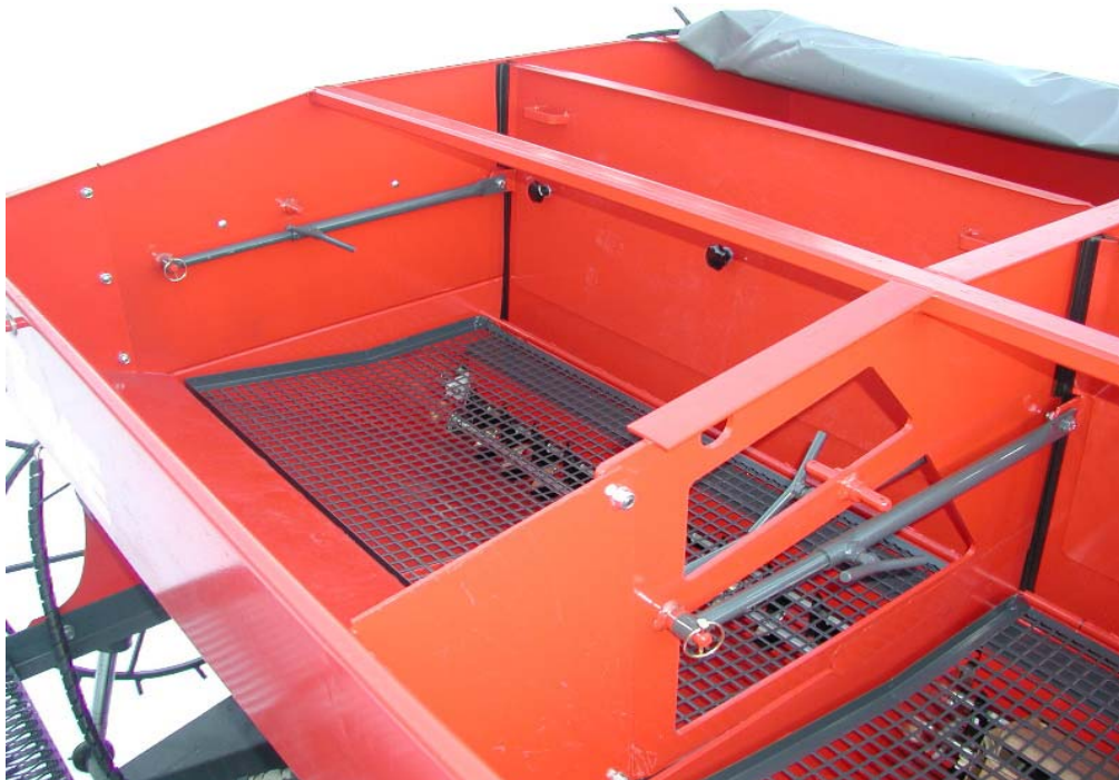
Fig. 3. Behållaren med den skjutbara mellanväggen. (AGCO AB, 2004)
