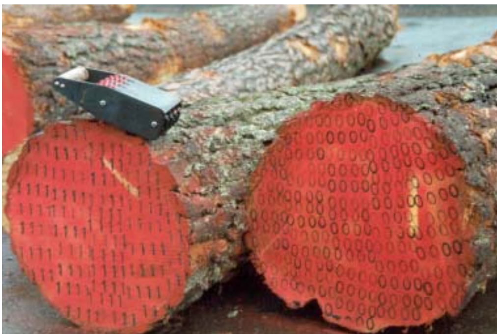
Figur 3. Bild tagen vid märkningstillfället. Stockarna målades först vartefter noggrann stämpling utfördes.
