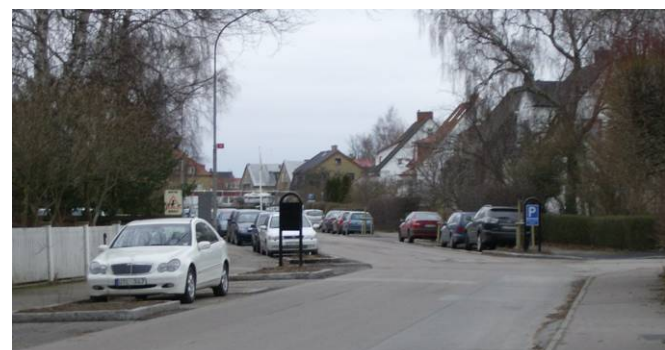
Figur 9, Avsmalning med fasta parkerings- fickor.
