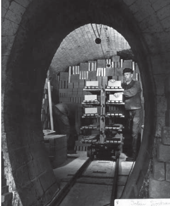
▲ Ekeby, början av 1900-talet. Stapling av klinker inför bränning i ringugnen. Bild från Höganäs CC.
