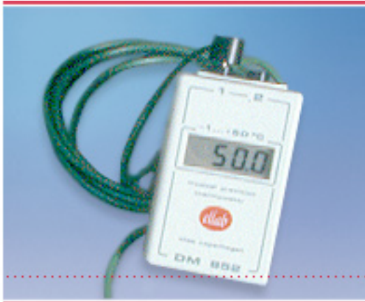
Figur 6. Denna termistor är en DM 852 och mäter temperaturer från -1 C° till +50 C° med \pm 0,1 C° noggrannhet.
