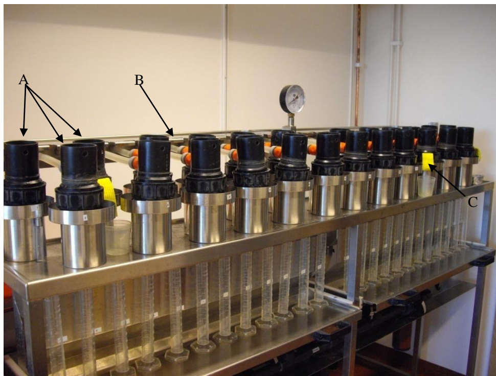
Figur 2. Bild av permeabilitetsapparaturen. Förlängningscylindrarna (A) är här fästa på proverna och kopplade till en jämn vattenyta (B). Från vissa förlängningscylindrarna syns vattenavledning från en läckande övre skarv med hjälp av disktrasa (C).
