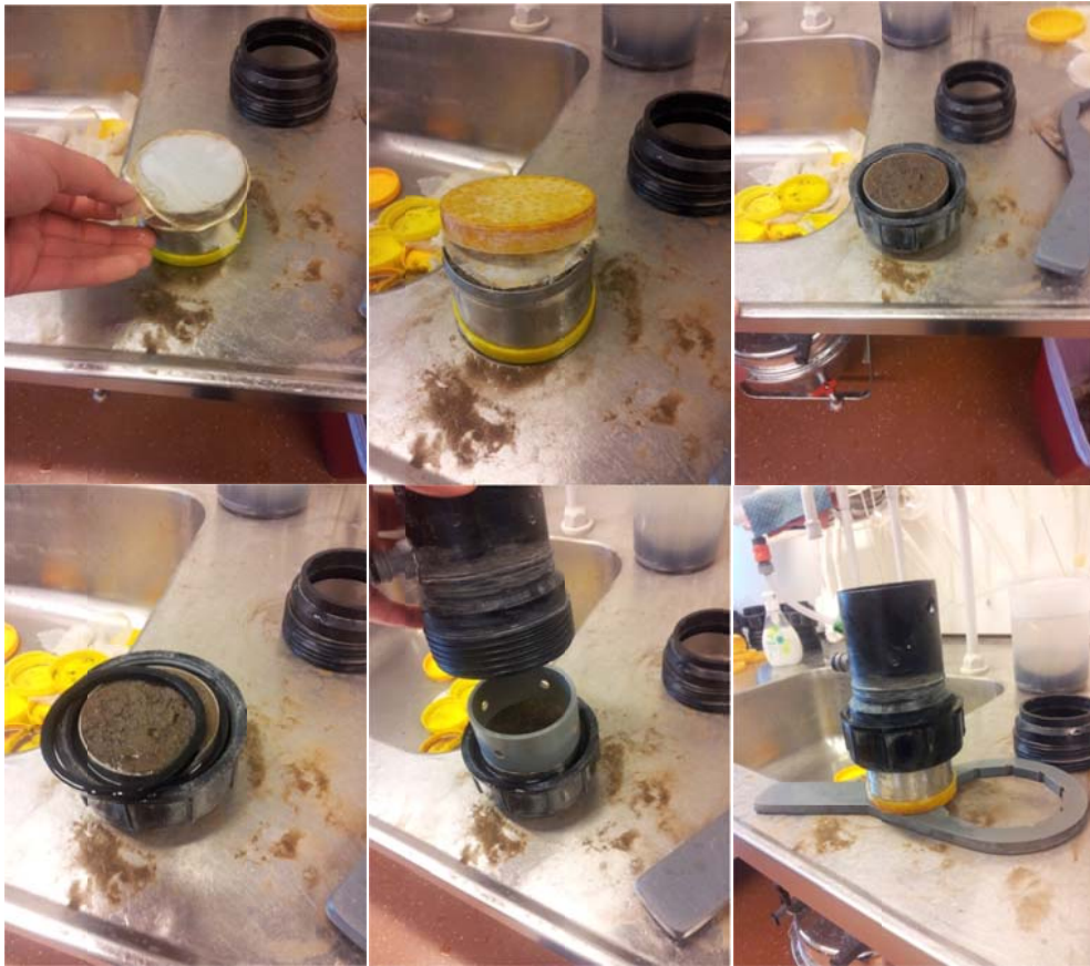
Figur 11. Ordningsföljden för hur cylindrarna monterades in i provmaskinen, från vänster till höger, uppifrån och ner.
