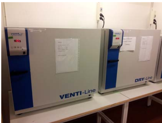
Figur 14. Visar hur ugnarna såg ut som användes för torkning av cylindrarna.
