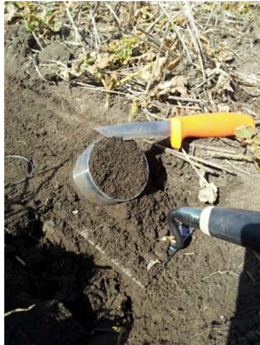
Figur 8. Figuren till vänster visar spackelspaden för uppgrävning av cylinder. Figuren till höger visar cylindern på spackelspaden och kniven för att skära rent cylindern.
