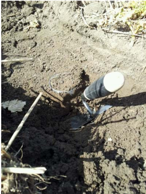
Figur 8. Figuren till vänster visar spackelspaden för uppgrävning av cylinder. Figuren till höger visar cylindern på spackelspaden och kniven för att skära rent cylindern.
